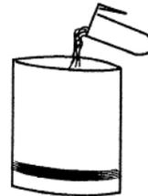
2. Verser 450 mL (environ 16 onces) d'eau propre dans le sac et vérifier s'il y a des fuites. Remplacer le sac si des fuites sont notées.
