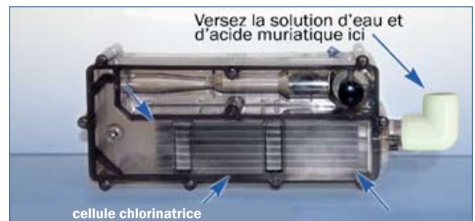
Figure 24 - Nettoyage de la plaque de cellule chlorinatrice
