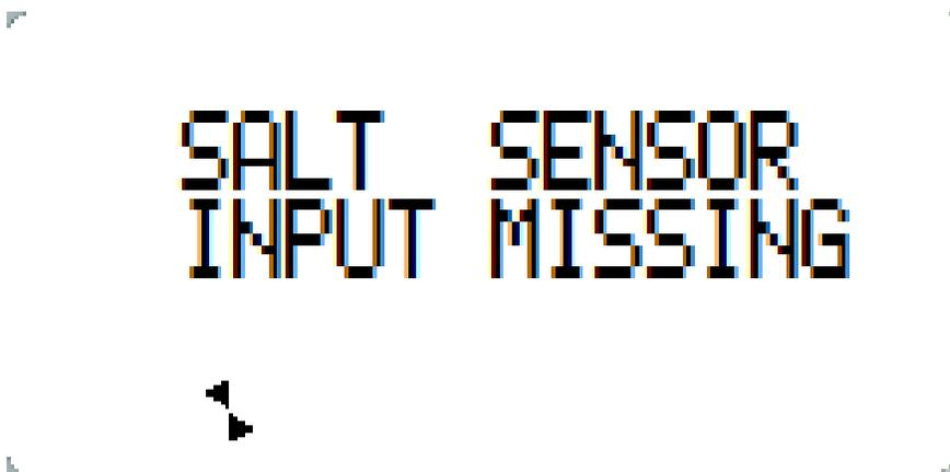
Pour éviter un arrêt et démarrage continuels du système, le système possède un délai de démarrage de 60 secondes. Pendant ce délai, l'écran ci-dessous s'affiche.
