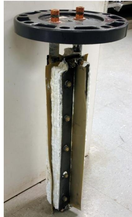
Une pile de cellules avec des plaques recouvertes de calcium.
