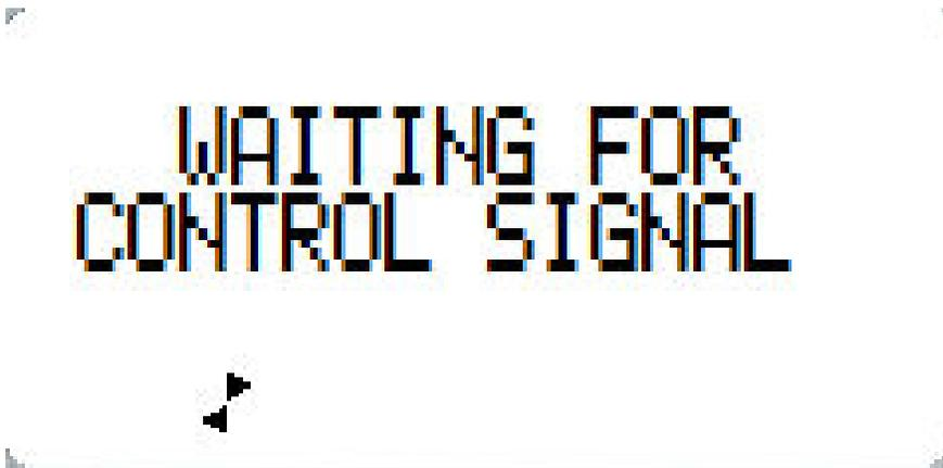
L'écran ci-dessous s'affiche lorsque le système ne détecte aucun débit à travers le boîtier de la cellule électrolytique. Cet état arrêtera la production de chlore. Lorsque le débit revient, le système redémarre automatiquement et cet écran disparaît.
