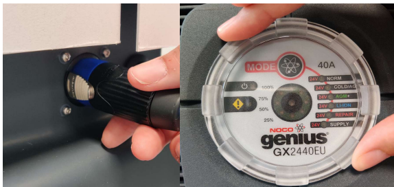
Figures 5 et 6. Recharge du robot à l’aide d’un chargeur de secours
