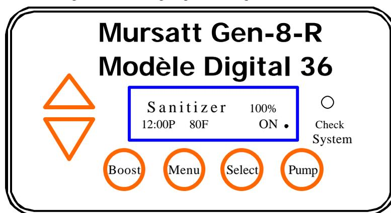
Le **NIVEAU DE PRODUCTION** est ajustable de 0% à 100% en appuyant sur les boutons de flèches Haut/Bas. Peu d'ajustement est nécessaire une fois que le réglage initial est fait.
