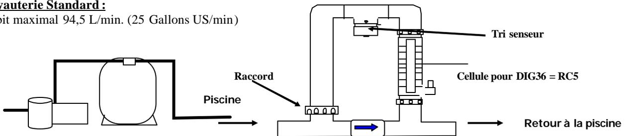
Pour d'autres configurations de plomberie, contacter votre détaillant.
